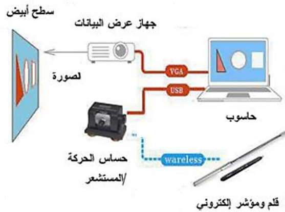
الصورة رقم (11): المكونات المادية للسبورة التفاعلية البديلة
