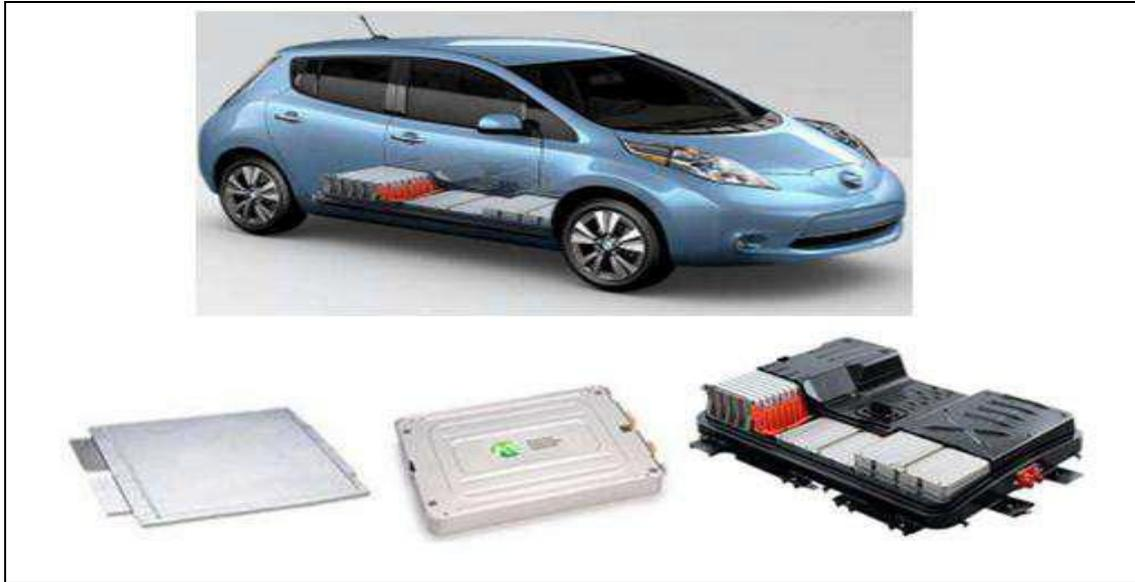
**Figure 1.14** : Pack de batterie Li-ion de 24kWh pour le véhicule électrique Nissan LEAF [13].
