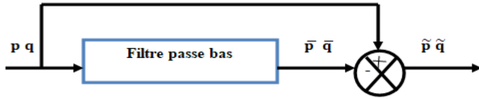
Figure III.6: Schéma représentant le principe de séparation des puissances.
