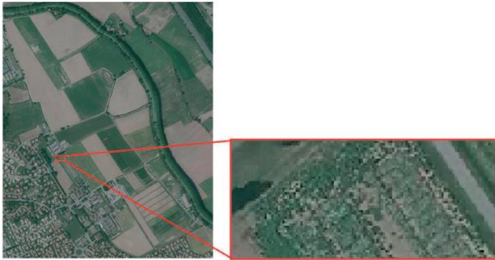
Figure 2.3 Exemple de photo aérienne, sur le zoom les pixels qui caractérisent l'image raster, sont bien distingués
