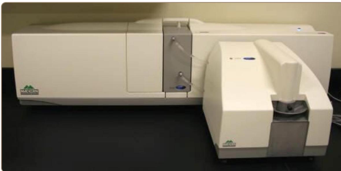
Figure 6: Granulomètre laser Mastersizer 2000 de MALVERN
