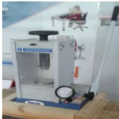
الشكل II-12 ضاغطة ميكانيكية من نوع Specac.
