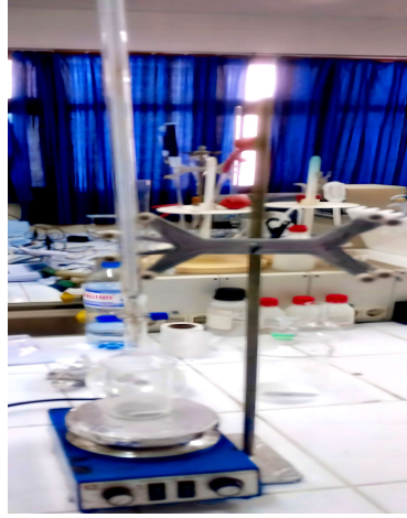
الشكل II-20 جهاز المعايرة.
