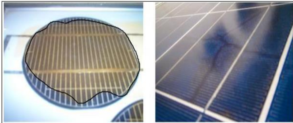
Figure. II.2. Dégradation du module photovoltaïque par décoloration [4].
