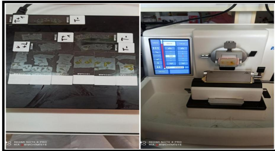
**Figure 31 : Préparation des coupes fine par microtome (Photo personnel).**
