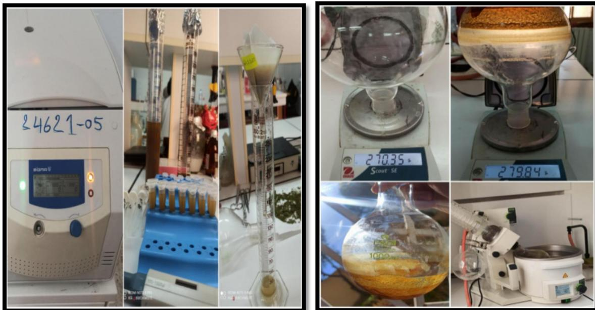
**Figure 20 :** les étapes de préparation de l'extrait par rotavapor (Photo personnel).
