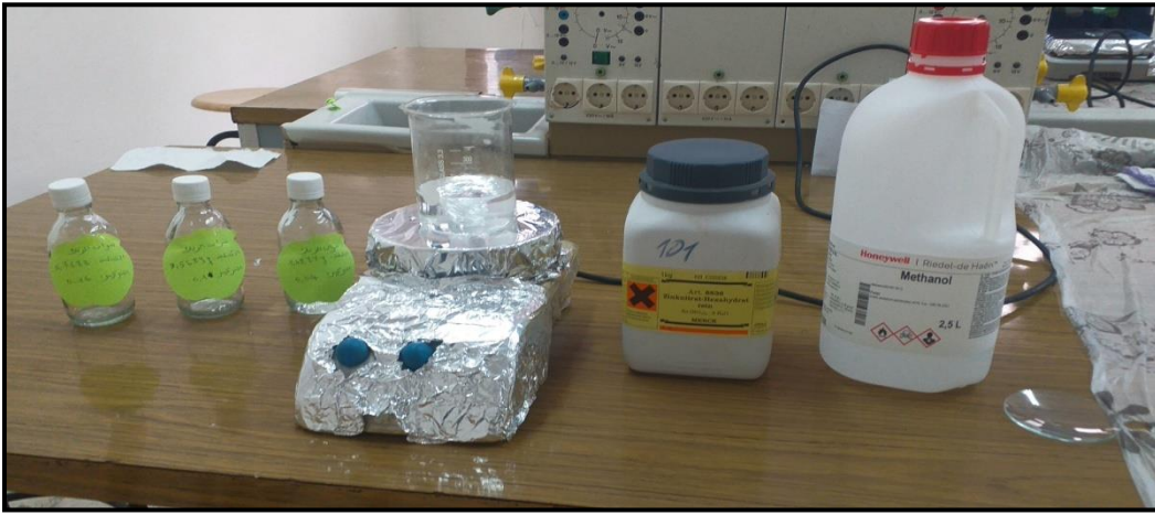
الشكل (II-9): الأدوات المستعملة في تحضير المحلول.
