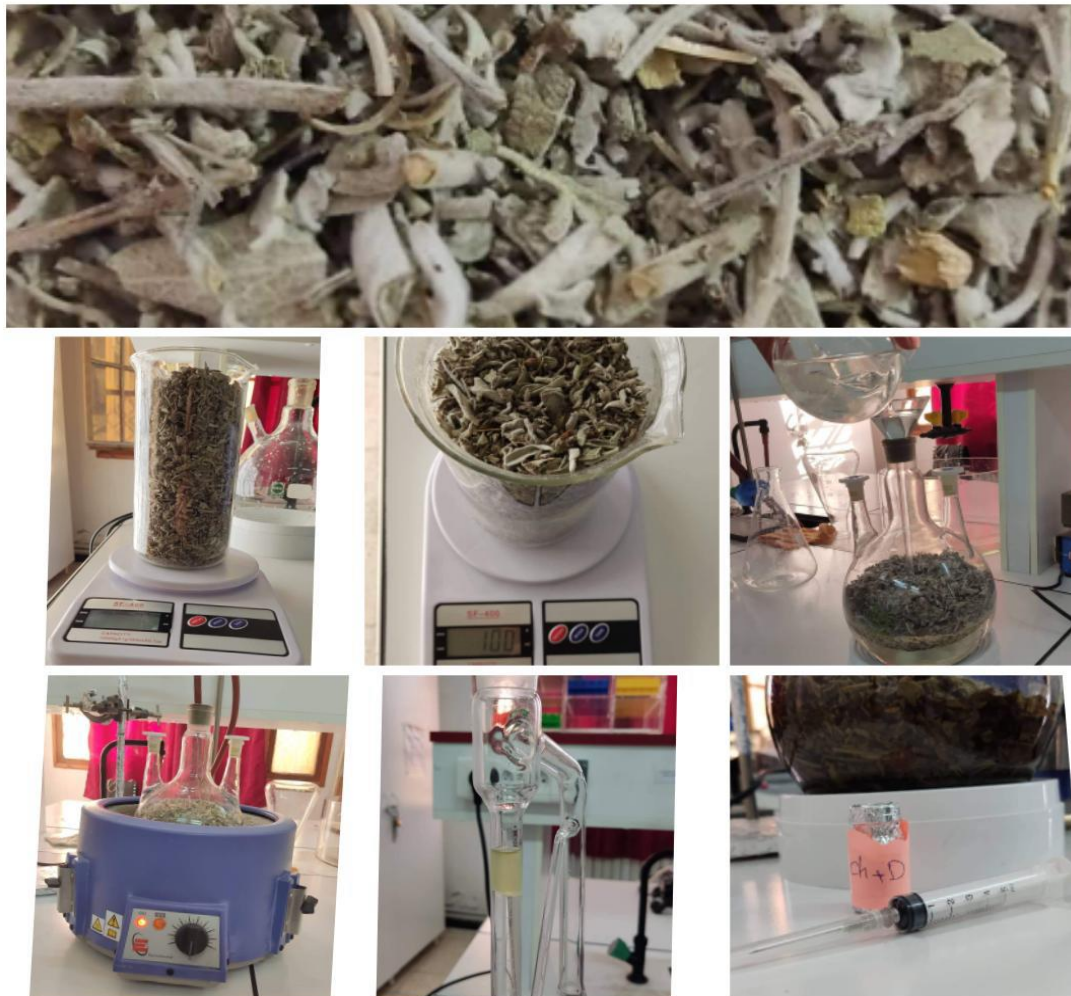
Figure22 : Les étapes de l'extraction de l'HE (D et H).
