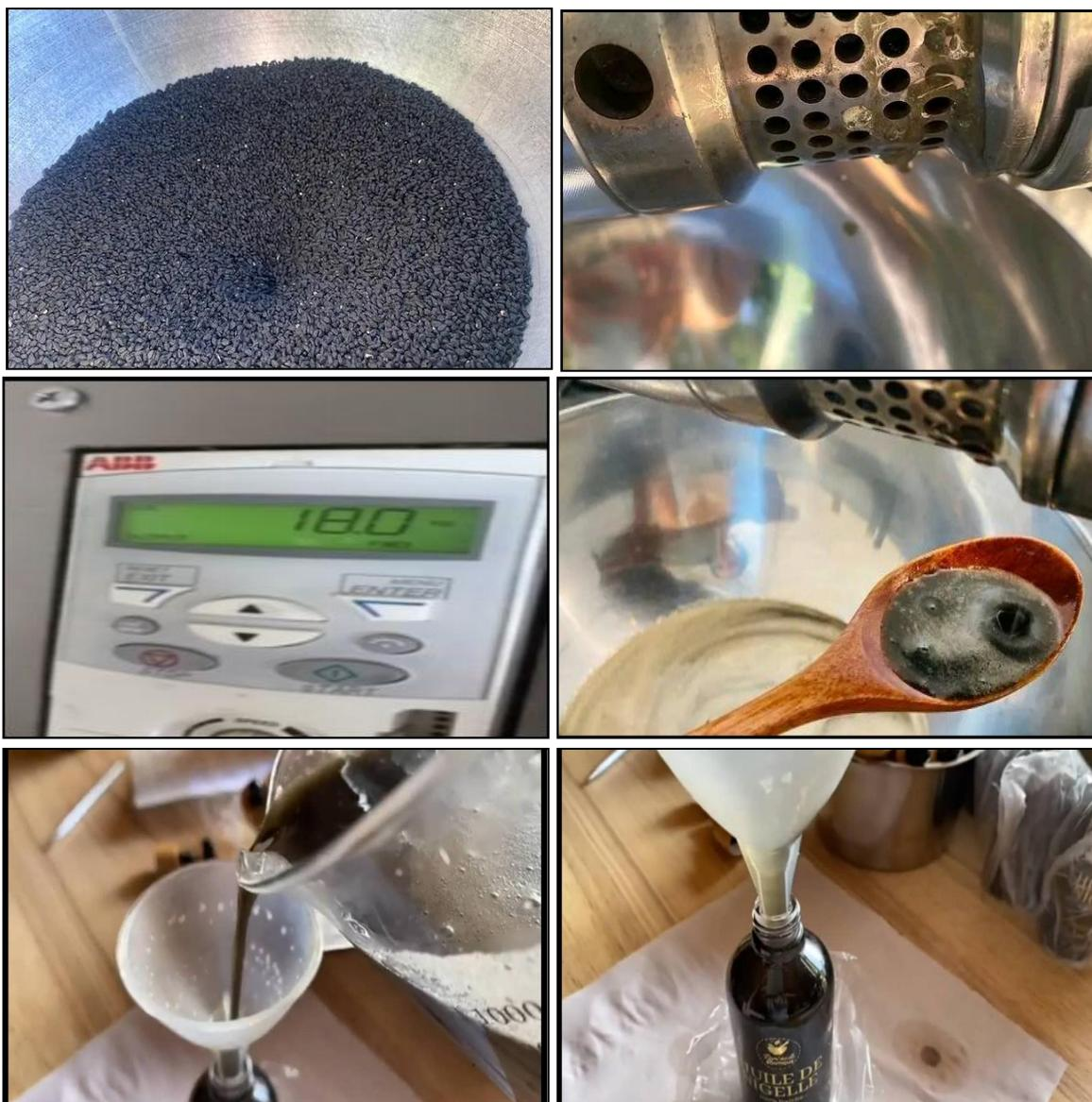
Figure 11. Méthode d'extraction d'huile de nigelle pressée à froid
