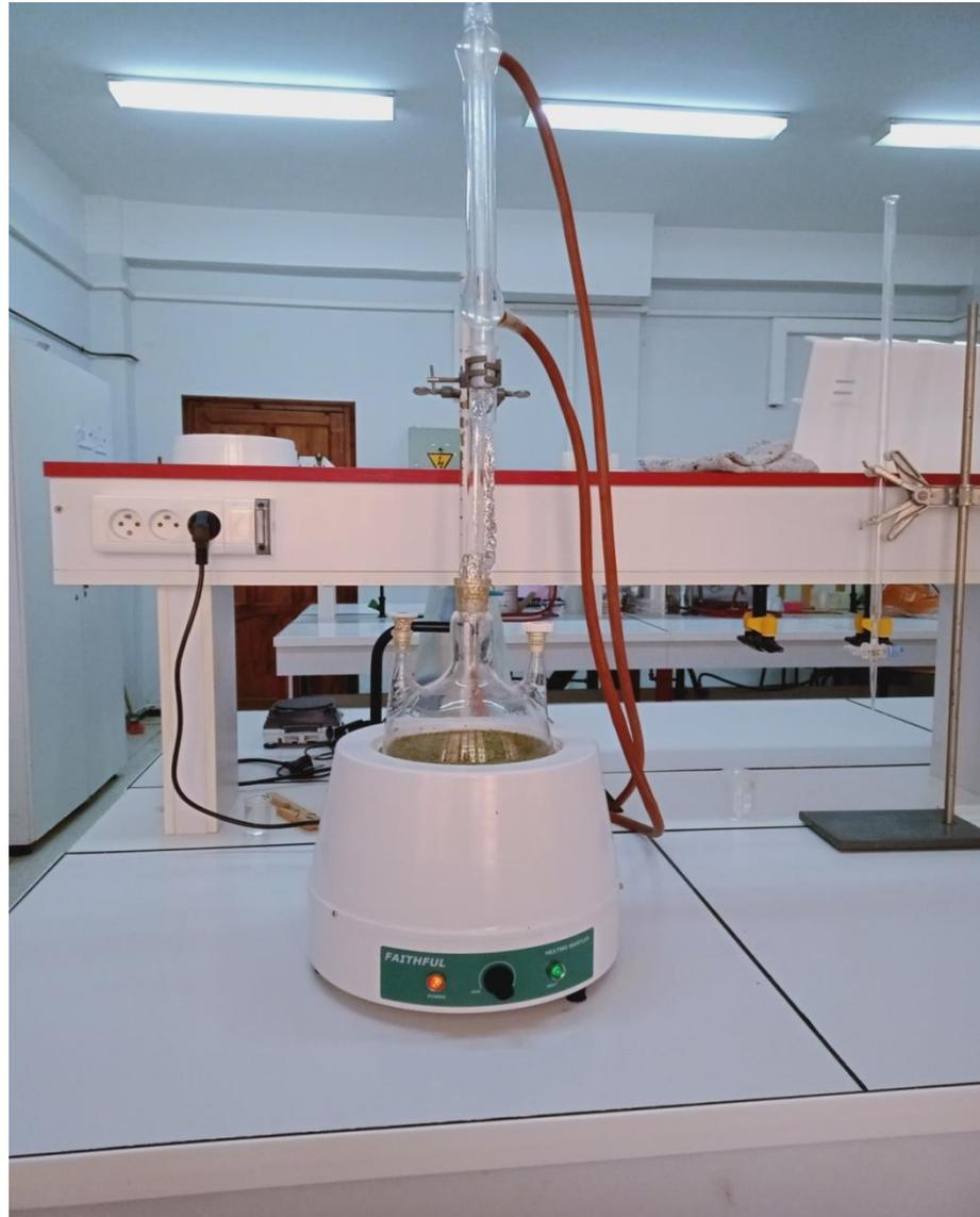
**Figure 16 :** l'hydrodistillation de type Clevenger
