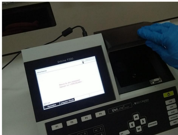
Mesure de l'absorbance à une longueur d'onde de 625 nm
