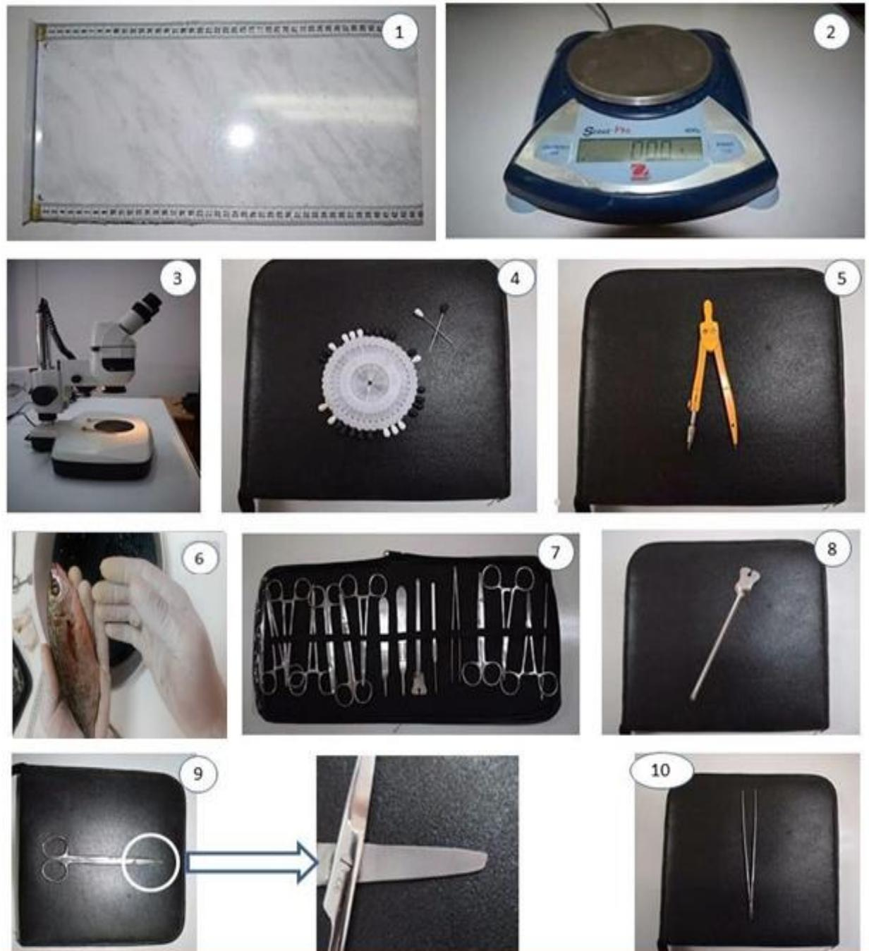
**Figure 4:** Matériel utilisé dans le laboratoire. 1: ichtyometre. 2 : balance. 3 : loupe binoculaire. 4 : Des épingles. 5 : compas. 6 : poisson *sarpa salpa* 7 : trousse de dissection (pince, ciseau fort, sande canonique). 8 : sande canonique 9 : ciseau fort. 10 : Pince.
