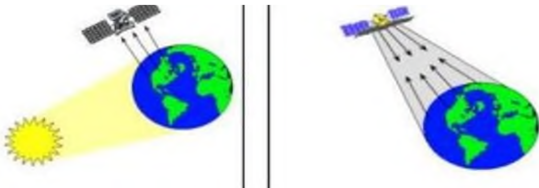
Figure 9: Principe de la télédétection passive et active.
