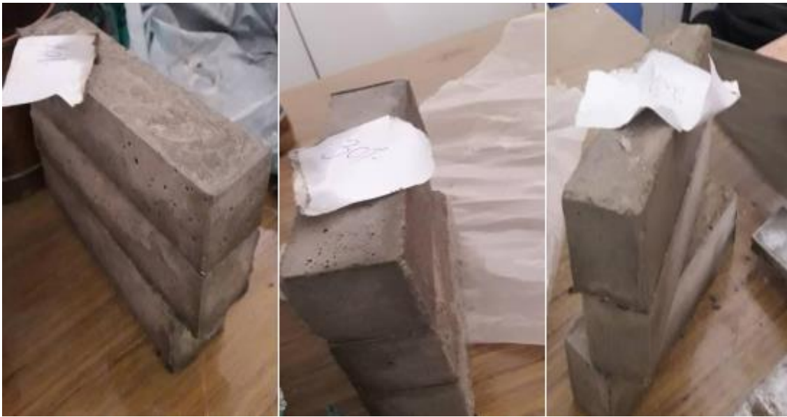
Figure (VI.5) Les mortiers réalisés à base de perlite en différents proportions
