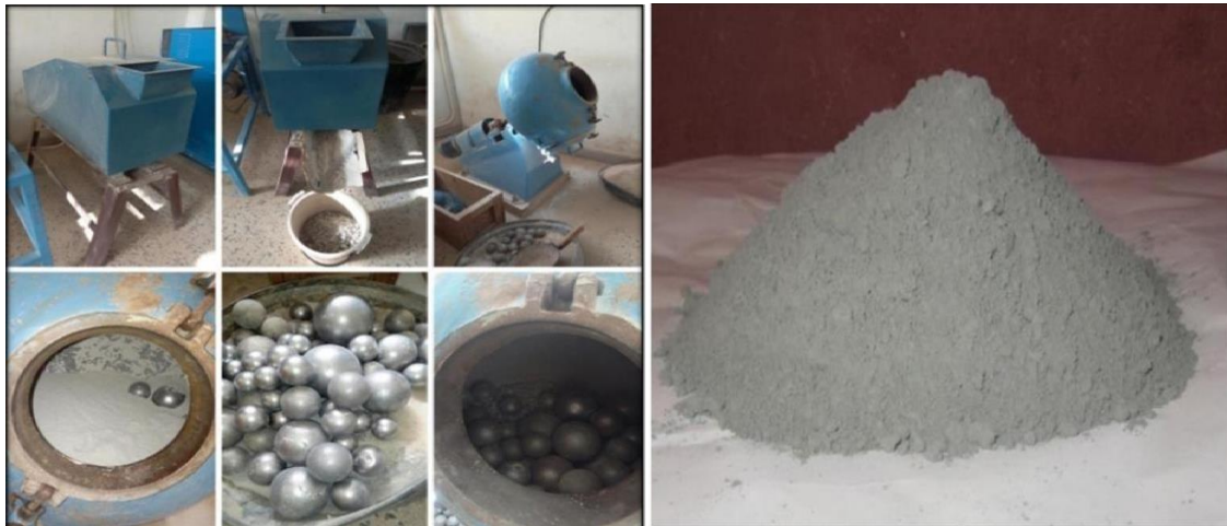
Figure (IV.2) : Concassage et broyage de la roche Figure (IV .3) : perlite poudre après le broyage et tamisage
