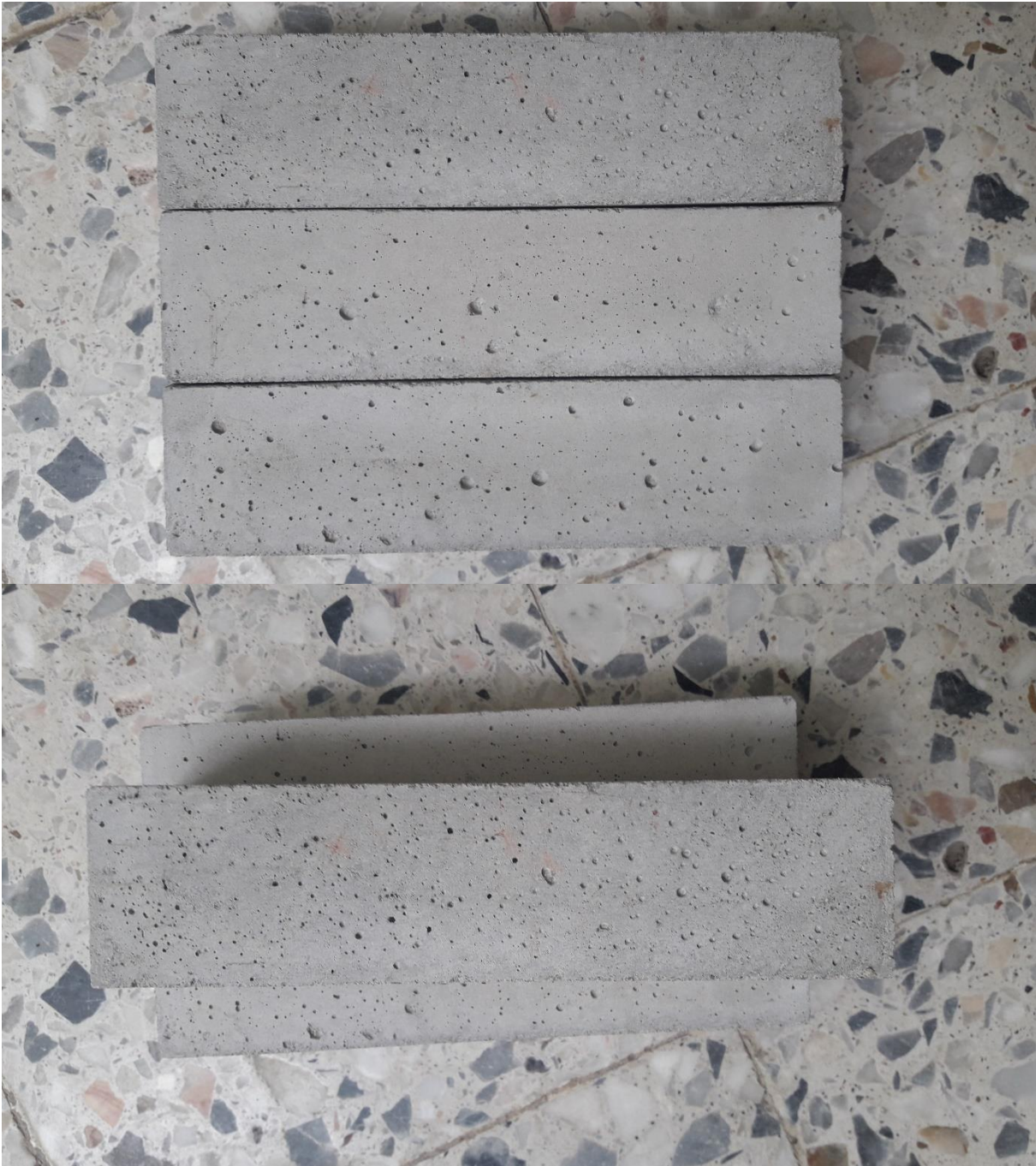
Fig (VI.6) .Prototype construction (béton léger)
