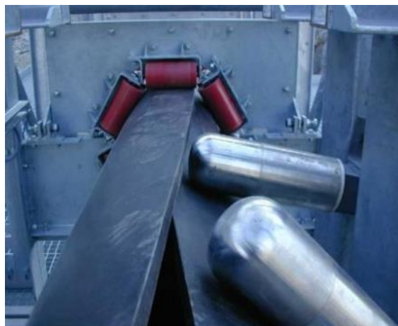
Figure 43 Etape de fermeture
