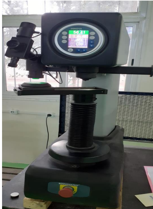
Figure III.7: Machine de dureté Brinell (INNOVATEST) (Université Badji-Mokhtar Annaba).
