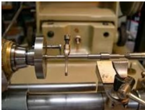
Fig.1.11 : Montage entre pointes.[21]
