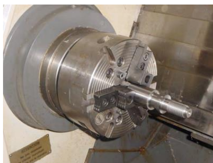
Fig. 1.9 : Montage en air.[19]
