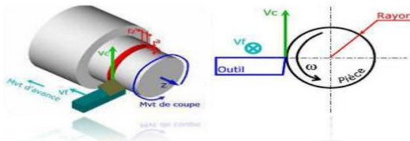
Fig. 2.2 : Conditions de coupe en tournage. [8]
