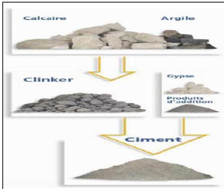
Figure 28 : Processus de fabrication du ciment[62]
