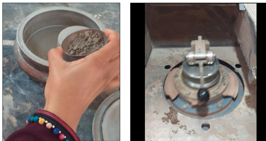
Figure III.17. Opération du broyage.
