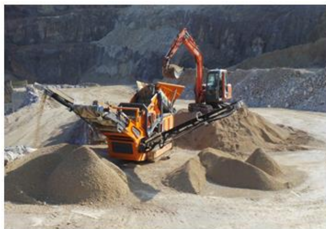
Figure II.5. Fragmentation complémentaire après extraction [5].
