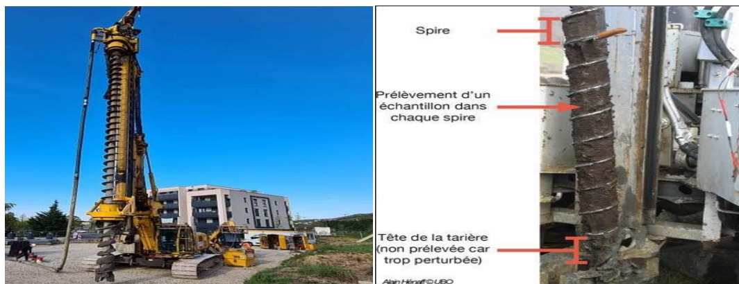
Figure II.4. Les tarières mécaniques[11].
