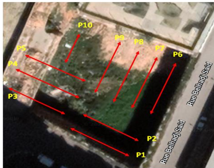
Figure IV.26. implantation des profils sismiques.
