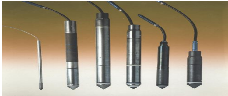
Figure II.28. Photographie de cônes CPT [27].
