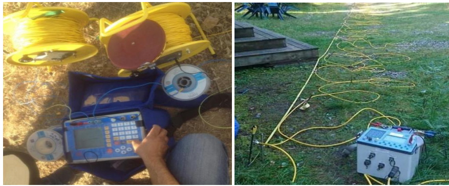
Figure III.3. Matériel et mise en œuvre de la prospection électrique.
