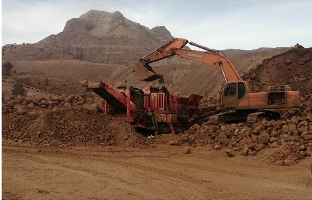
Figure IV.12 : un concasseur mobile concassée le minerai qui est dans les stocks dans la mine de l'Ouenza
