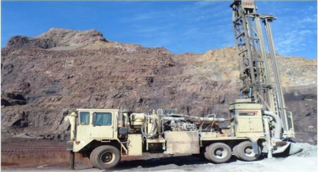
Fig. III.1. La sondeuse INGERSOLL-R(T4BH900HR4) en travail de mine del'Ouenza. [13]
