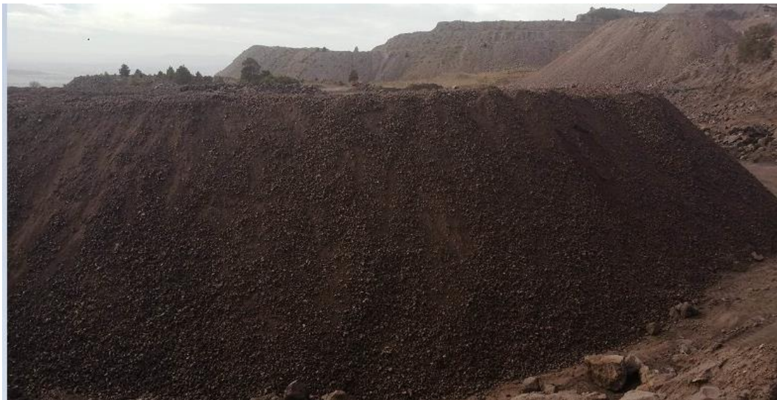
Figure IV.13 : minerai pauvre concassée et stocker
