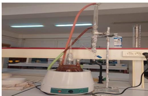
**Figure 11.** Appareillage d'hydrodistillation (photo personnelle)
