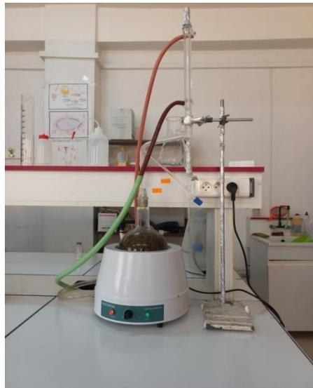
**Figure 20.** Montage de l'hydrodistillateur de type Clevenger ( photo personnelle, 2023
