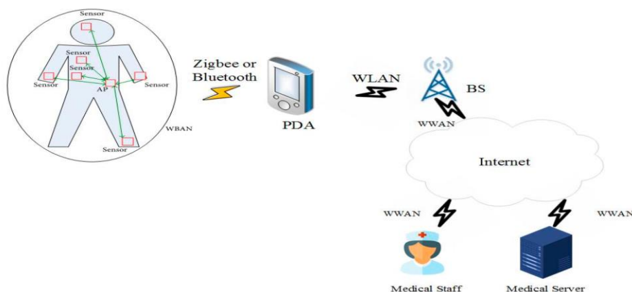
Figure 9 La technologie Bluetooth dans le réseau WBANs [7]
