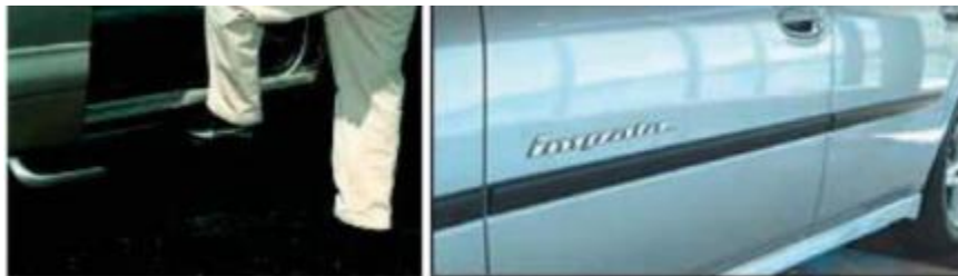
Figure 4 : Application des nanocomposites dans le domaine des automobiles, à droite des baguettes de protection latérale, à gauche les marches-pieds de mini-vans Chevrolet et GMC [59].
