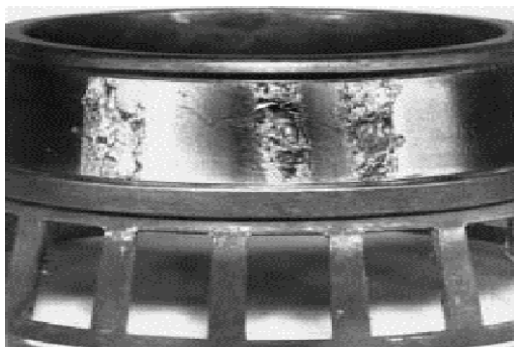
Figure I.5.a : Écaillage de fatigue.
