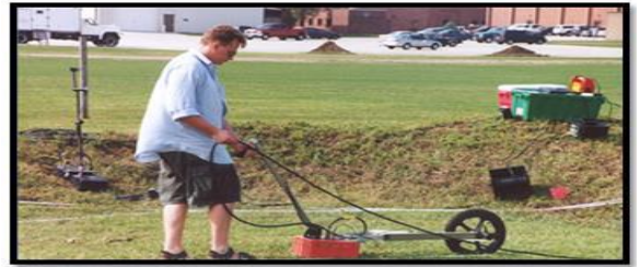
ش : ٨ . جهاز الرادار الأرضي .
