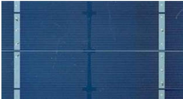
Fig. I.9. Cellules monocristallines.
