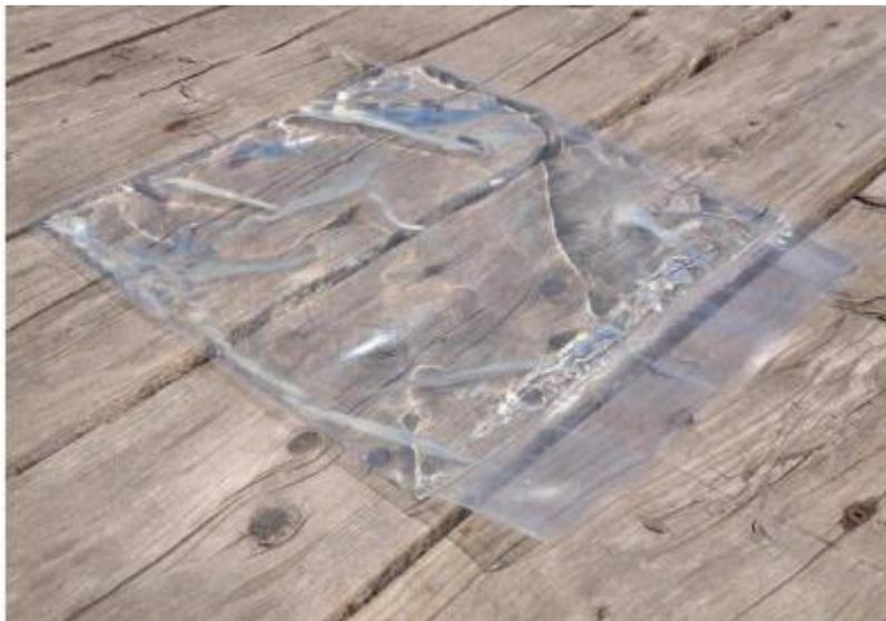
*Figure I.6. MCP macro-encapsulé dans un sachet en Polyéthylène [20].*
