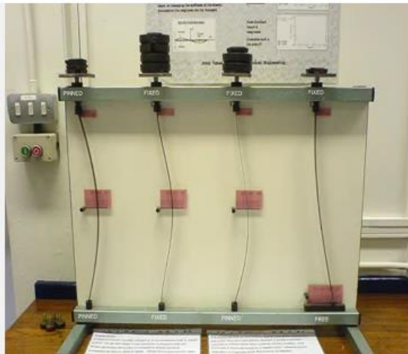
Figure 1.2 : Flambement d'un élément de poutre (colonne) pour diverses conditions d'appuis
