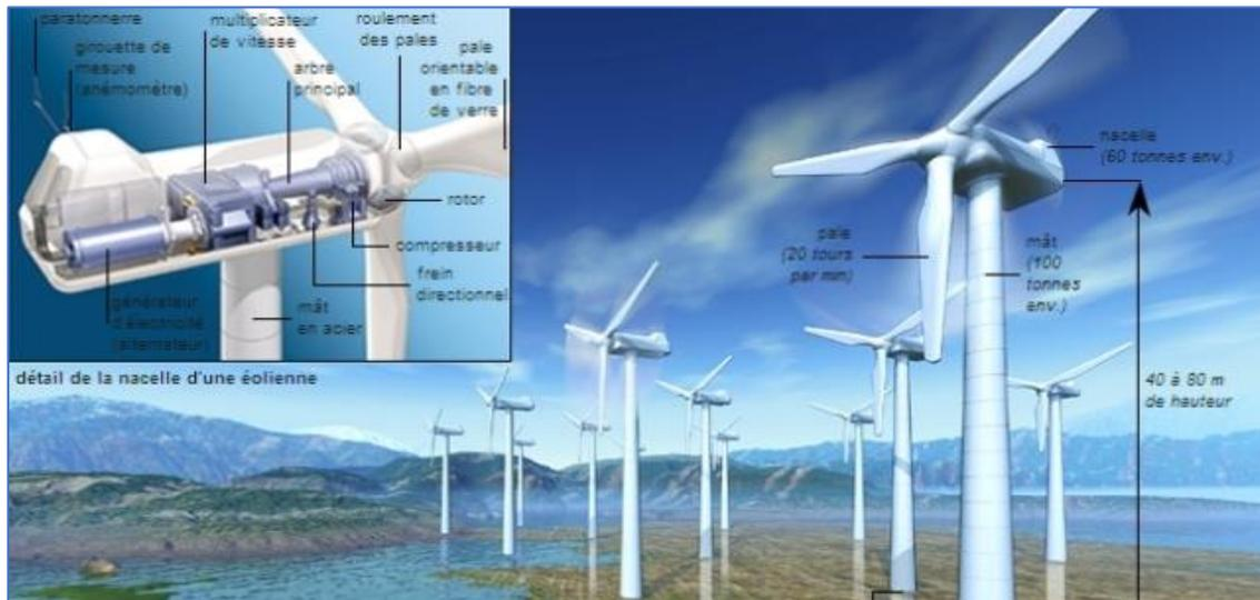
Figure II.2 L'énergie éolienne
