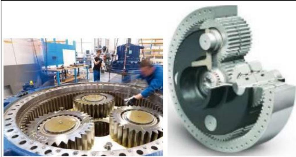
Figure III.41 Multiplicateur et ses engrenages.
