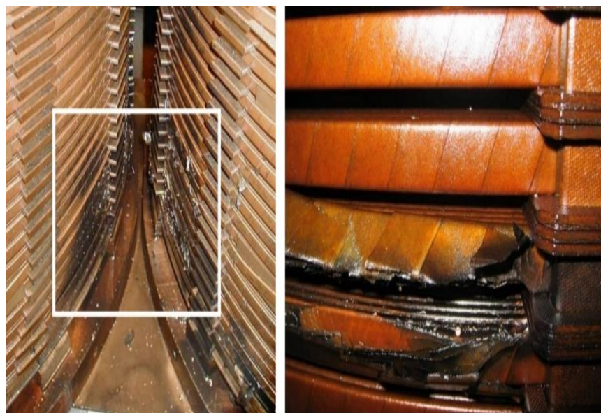
Figure (I.13) : (a) Amorçage entre enroulements, (b) Amorçage entre spires [43] [Jean Sanchez et al., 'Aide au diagnostic de défauts des transformateurs de puissance'. Université de Grenoble, 2011. Français. ffnnt: 2011 - GRENT031ff. fftel-01017179f.]
