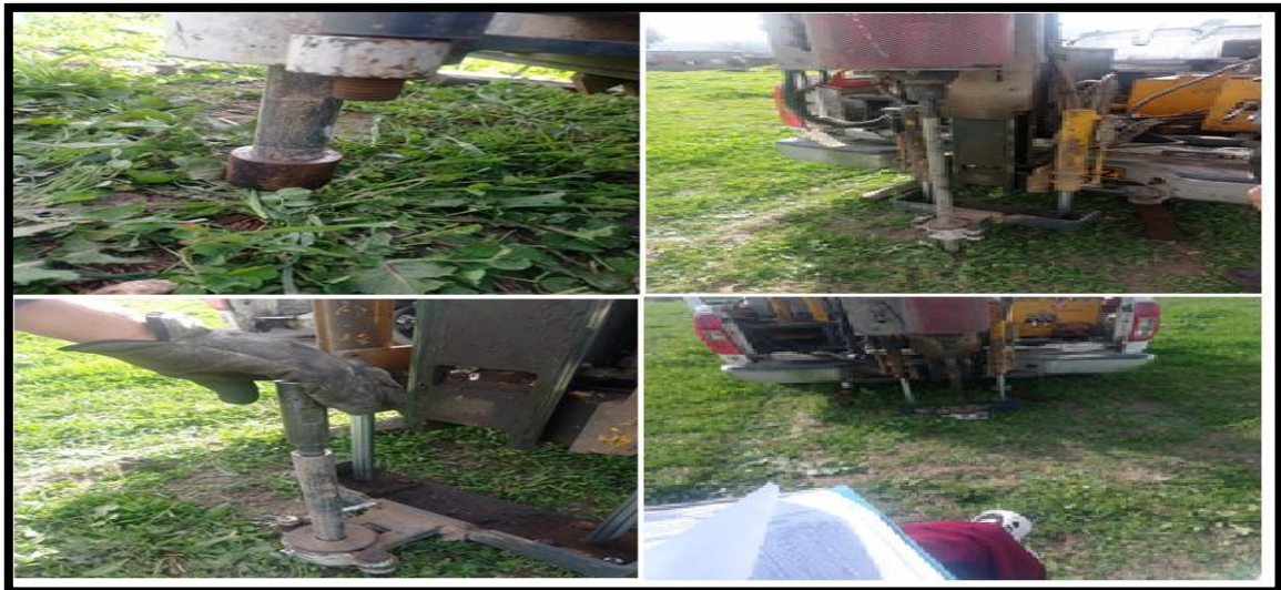
Figure II.11 : Essais de pénétromètre au carottier.
