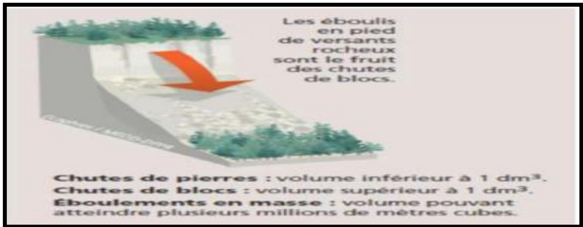
Figure I.15 : Schéma explicatif des phénomènes : les éboulements, chutes de blocs et de pierres [2]
