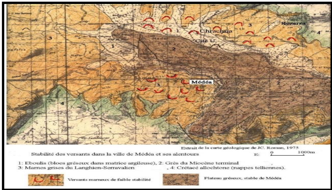
Figure II.2 : Stabilité des versants dans la ville de Médéa et ses alentours. [18]
