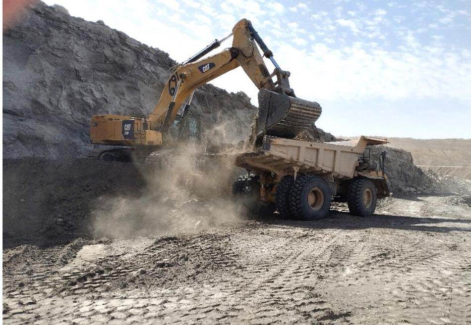
*Figure 10 : Processus de chargement par pelle hydraulique Caterpillar 390F (prise en 22/04/2024)*
