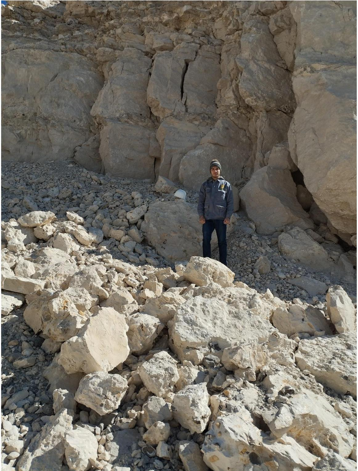
*Figure 21 : Les effets arrière de tir sur le massif rocheux (prise en 14/02/2024)*
