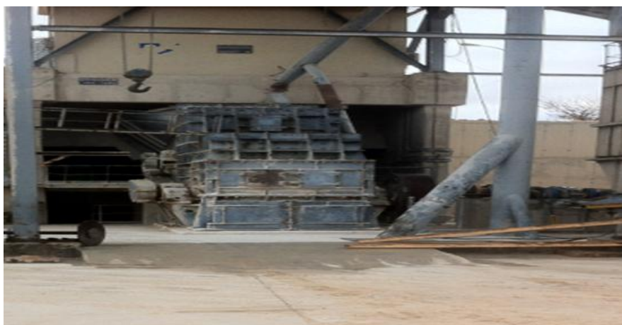
Figure IV.09 : Concasseur à marteaux
