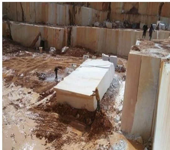
Fig III.10 : bloc abattus sur un matelas
