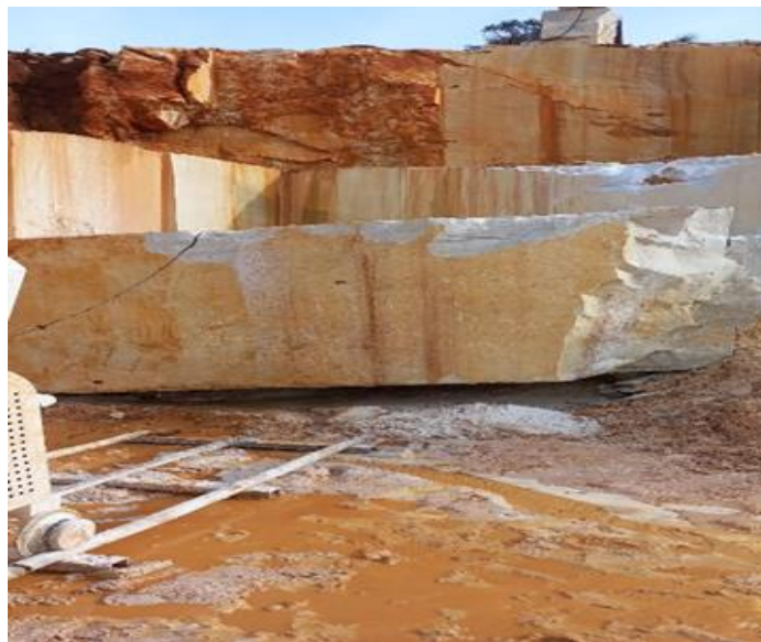
Fig III.11 : Débitage des masses
