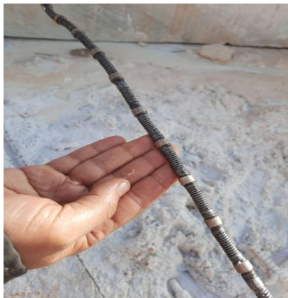
Fig III.06: un fil diamanté
