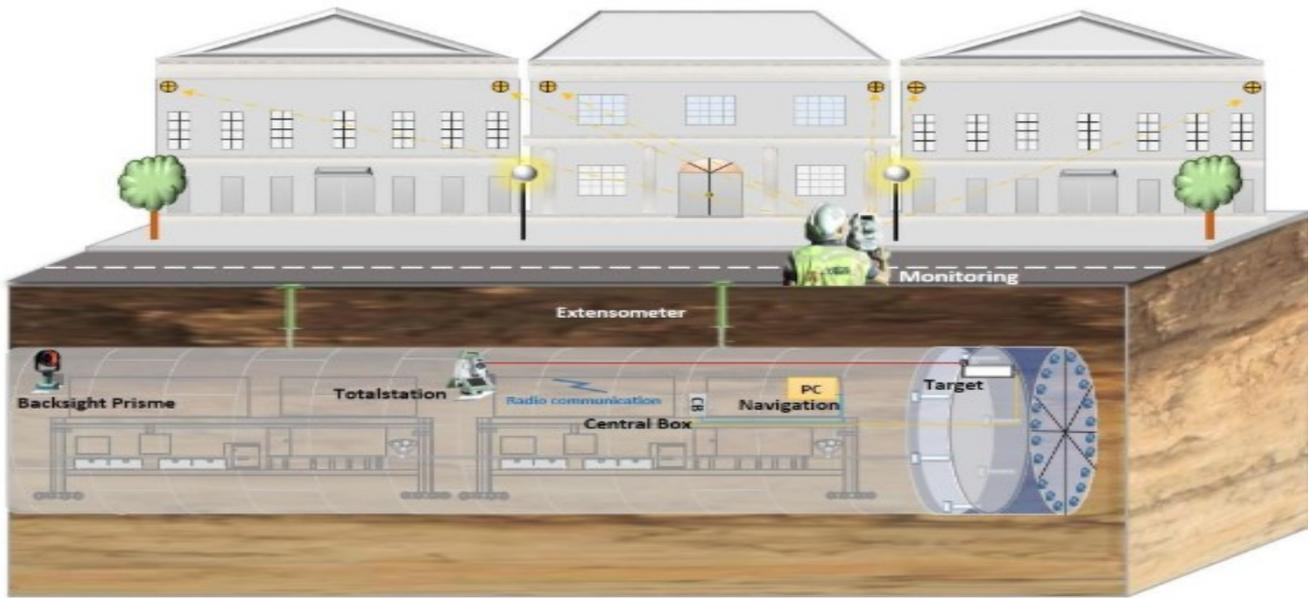
**Figure 3 :** Système d'auscultation tunnelier et monitoring
