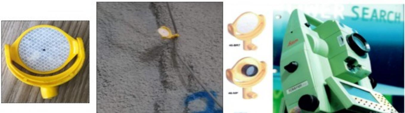
**Figure 4 :** Cibles rétro-réfléctrices et l'appareil de mesure (pour prendre des mesure topographique)
