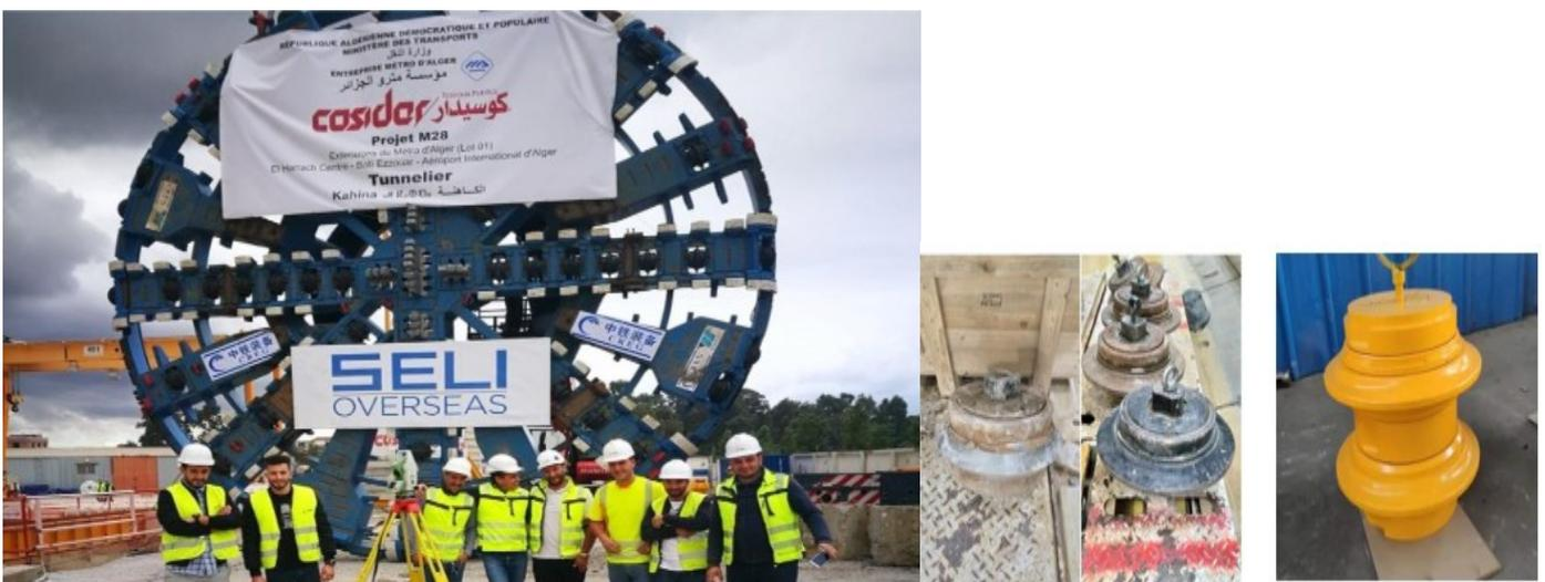
**Figure 2 :** Tête de coupe de tunnelier /molettes (parmi les outils de coupe de front de taille).
