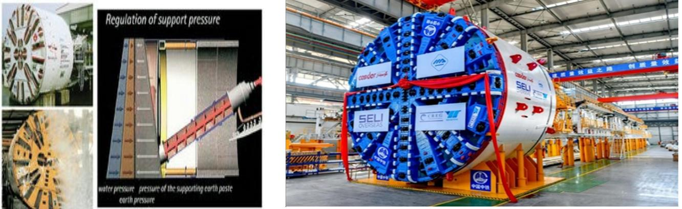
**Fig. II.7** : tunnelier à pression de terre EPB
