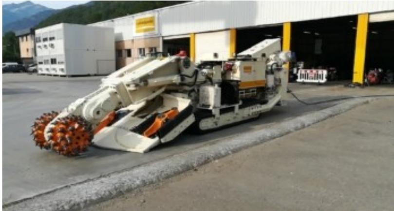
**Figure I.16** : Engin à attaque ponctuelle
