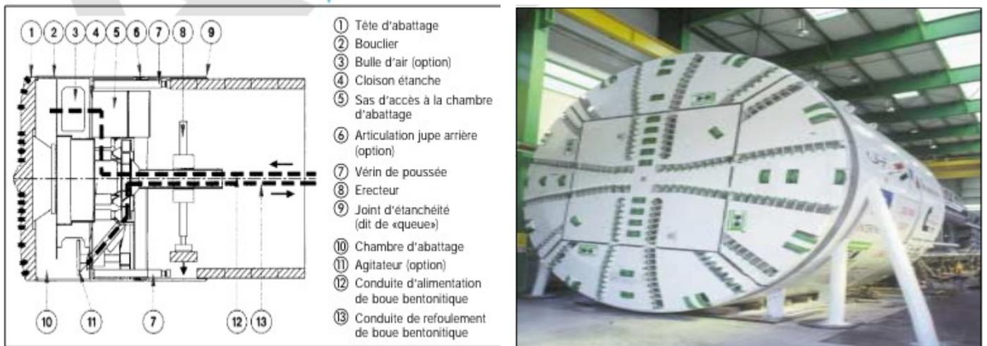
Figure II.6 : Tunnelier à confinement de boue [15]
