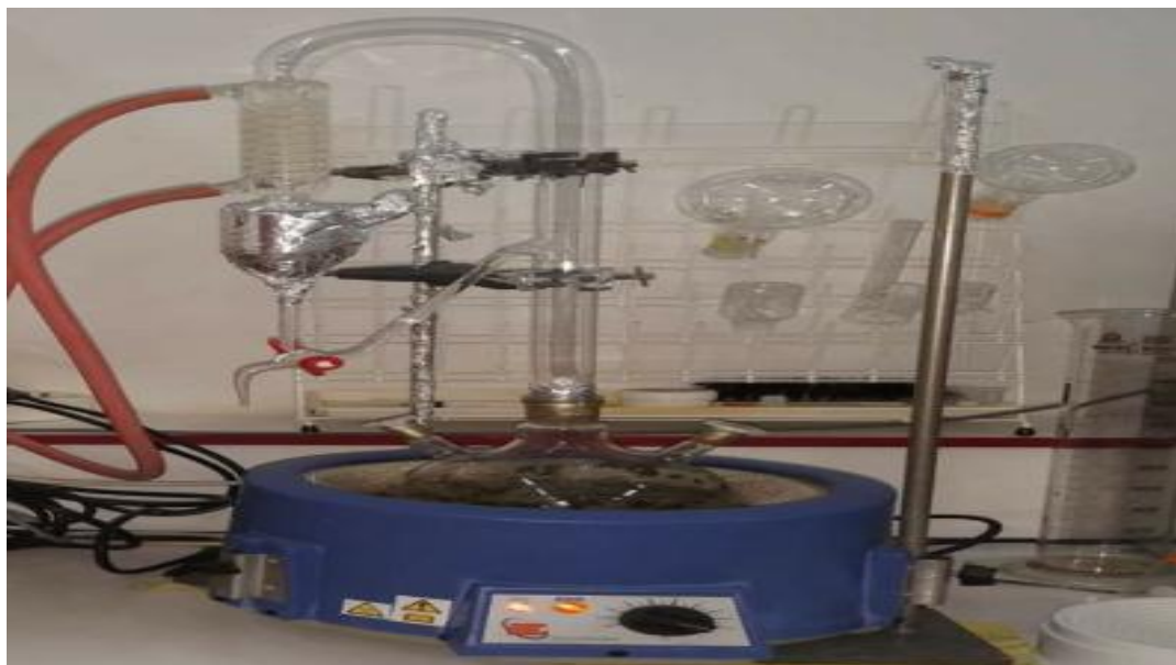
Figure 19 : Montage de l'hydrodistillateur de type CLEVINGER (photo personnelle).
