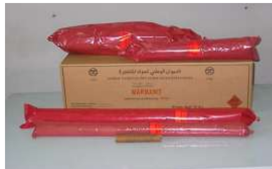
Figure II.3: Le sac d'Anfomil et Cartouche de Marmanite
