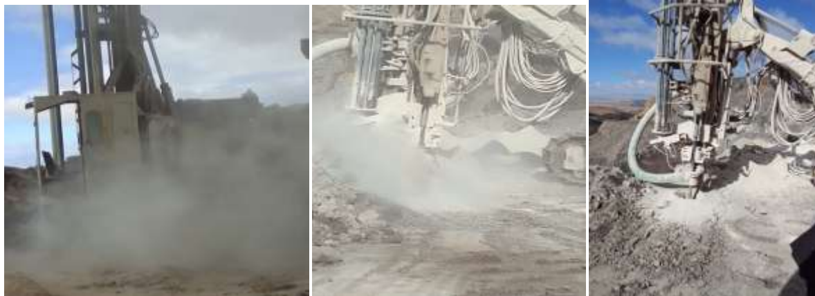
Figure. IV.1 : Foreuse avec tête aspiratrice
