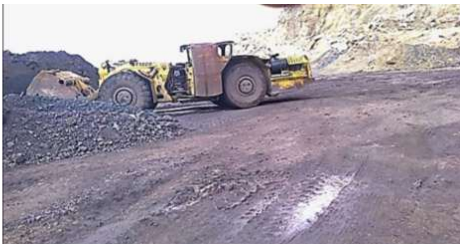
Figure II.12: chargeuse transporteuse pneumatique type ATLAS COPCO St 1020.
