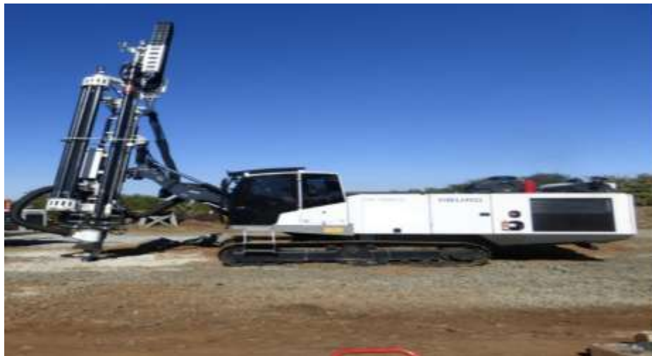
Figure. II.2 : Représente d'une sondeuse de type B. Burg HD 1500 D.
