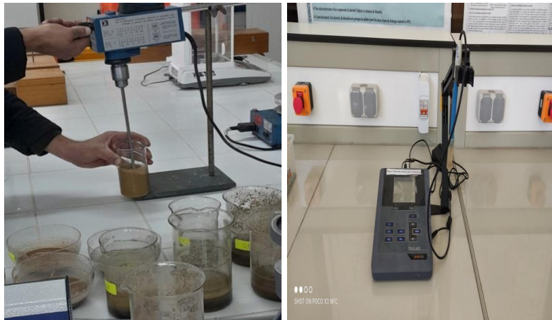
Figure 3.10 Mesure de l'acidité de sédiment de drague par un appareil de pH-mètre
