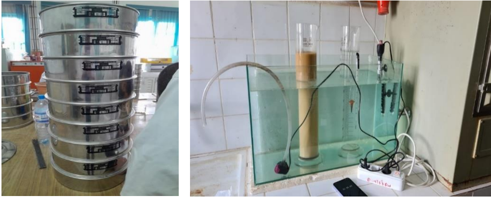
Figure 3.1 Matériels pour analyse granulométrique par tamisage et par sédimentométrie
