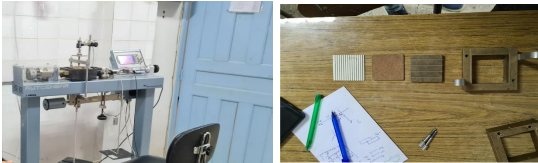
Figure 4.1 Appareillage de l'essai de cisaillement
