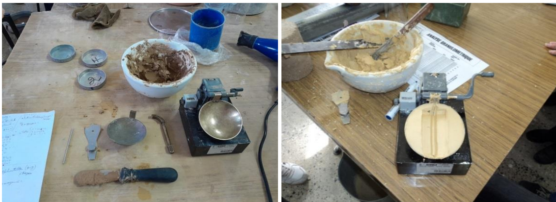
Figure 3.5 Appareillage pour l'essai des limites d'Atterberg
