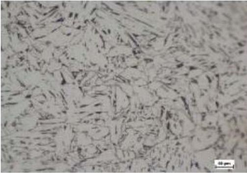
**Figure IV.6: microstructure de la ZAT (soudure Automatique)**
