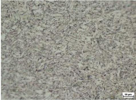
**Figure IV.7: microstructure de la ZF (soudure Automatique)**
