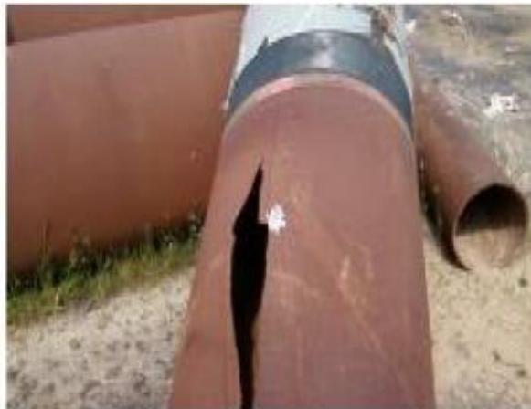
Figure III.2.Éclatement d'un pipeline [47]
