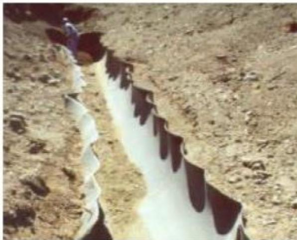
Figure III.2.3 Éclatement d'un pipeline [46]
