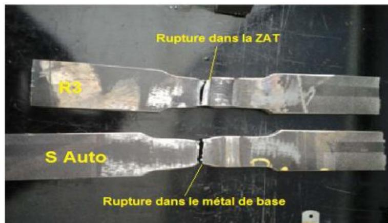
Figure IV.14 : rupture d'éprouvette de traction[47]
