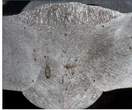
**Figure IV.4 :** macrographie de la soudure
