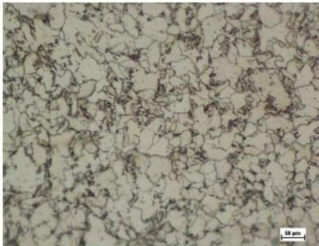
**Figure IV.11: microstructure de la ZF (deuxième réparation)**
