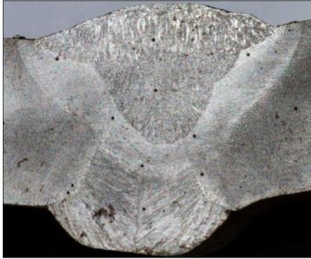
**Figure IV.3 :** macrographie de la soudure
