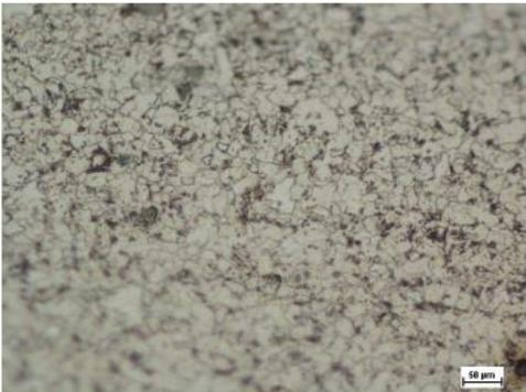
**Figure IV.8: microstructure de la ZAT (Première réparation)**
