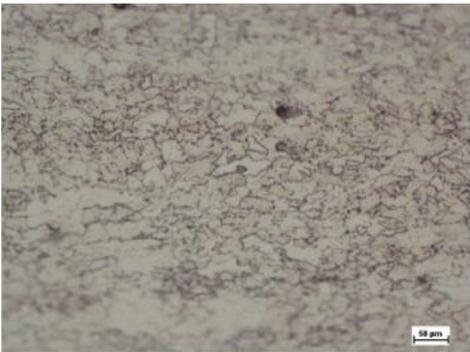
**Figure IV.10: microstructure de la ZAT (deuxième réparation)**
