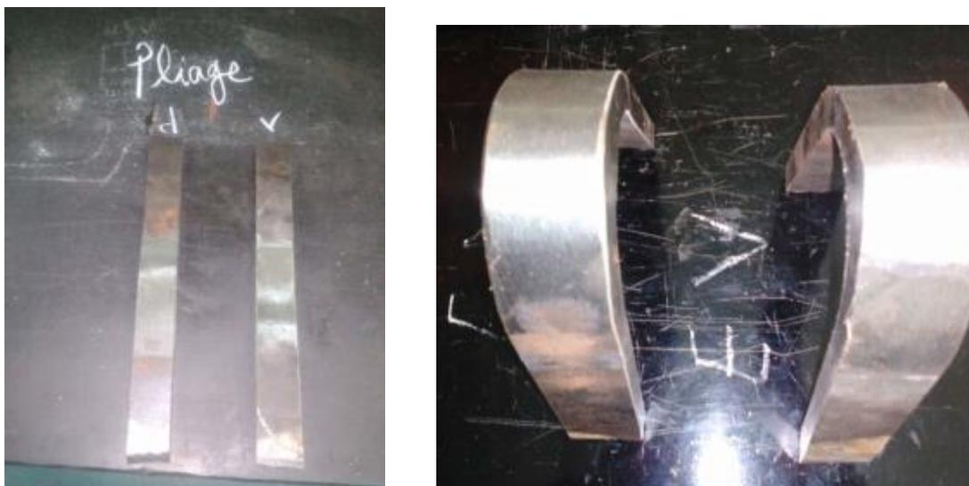
Figure IV.15: éprouvette de Pliage [47]
