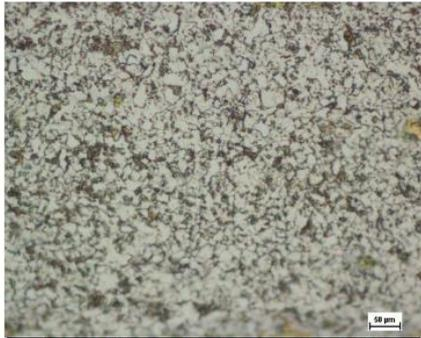
Figure IV.12: microstructure de la ZAT
