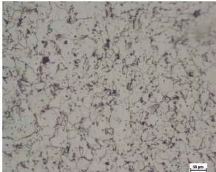
**Figure IV.9: microstructure de la ZF (Première réparation)**
