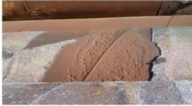
**Figure III.7.4.** Corrosion généralisée
