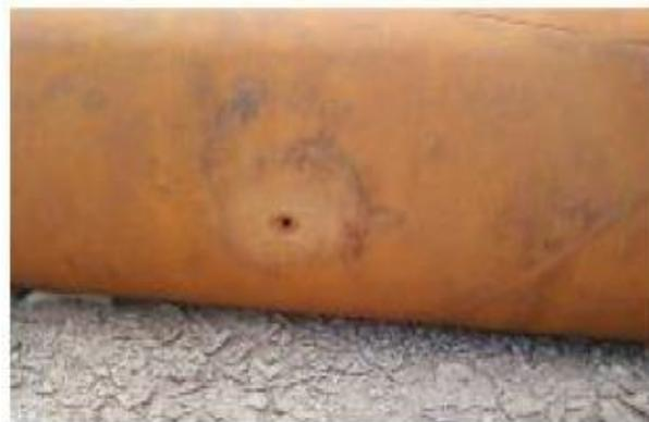
**Figure III.7.2.** Corrosion par piqure
