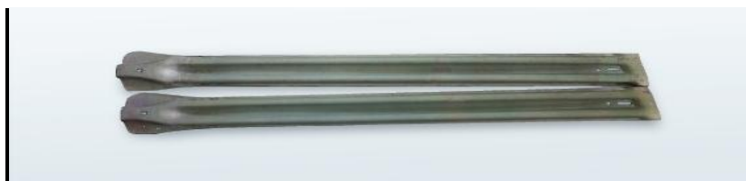
Figure I- 6: Renfort de porte (ép. : 1 mm) [10]
