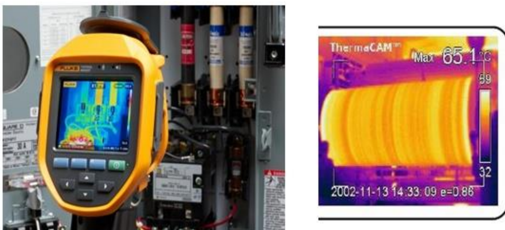
Figure II- 1: mesure température thermographe infrarouge.[5 ]
