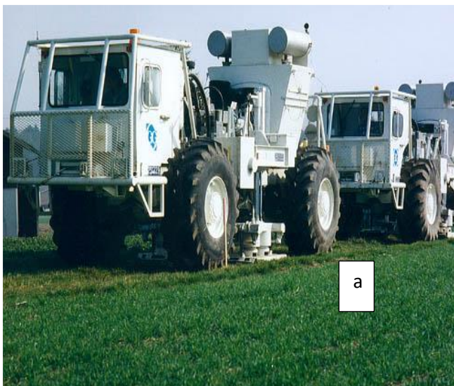
Fig. IV.8: a) Source: marteau, explosif, camion vibrateur b) Récepteur : Géophones
