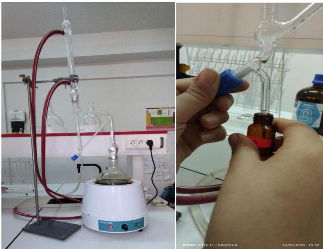
Figure03 : Montage d'hydrodistillation (photos originales).
