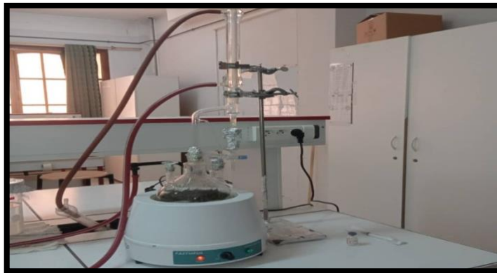
Figure 09: hydro-distillateur de type Clevenger (photo personnelle ,2024)
