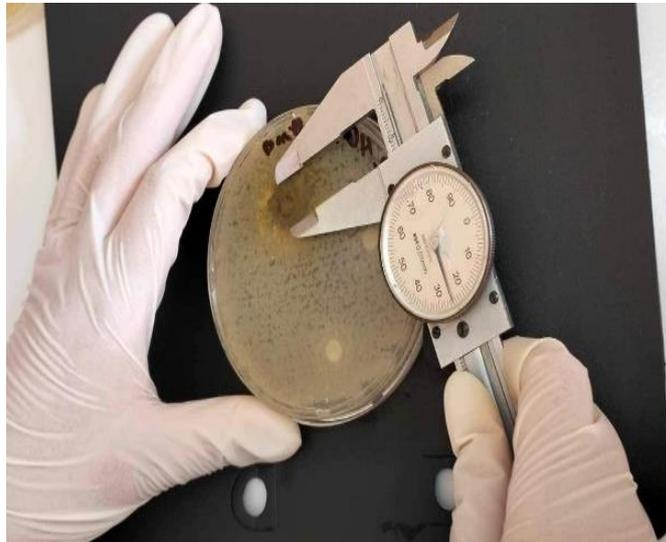
**Figure 11 : pied à coulisse pour mesurer le diamètre des zones inhibition (Photo personnelle., 2024)**
