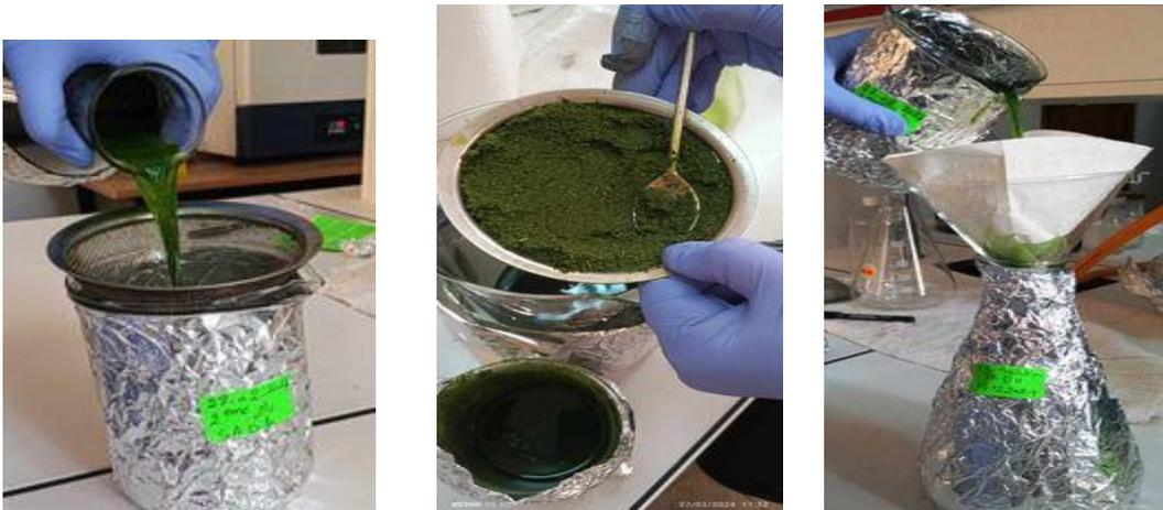
**Figure 5 :** Filtration de l'extrait hydro-éthanolique de *Lavandula dentata*
