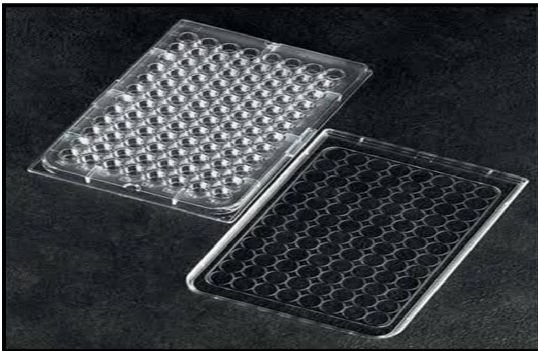
**Figure 11 :** Microplaque 96 puits à fond rond
