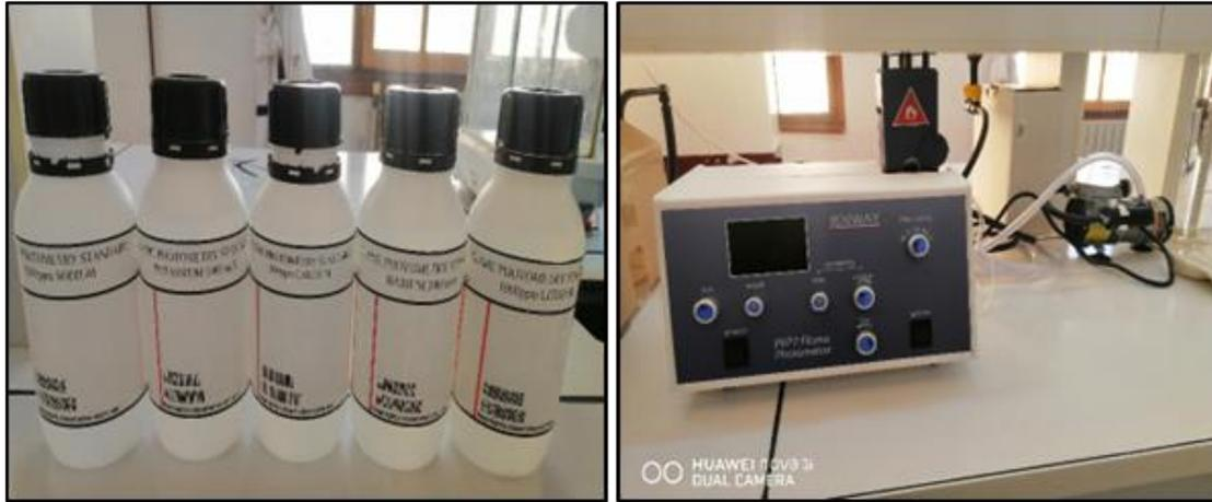
**Figure 7.** Dosage des éléments chimiques ( $\text{Na}^+$ ,  $\text{K}^+$ ,  $\text{Ca}^{++}$ , Ba et Li) à l'aide d'un spectre à flamme (photos personnelles).
